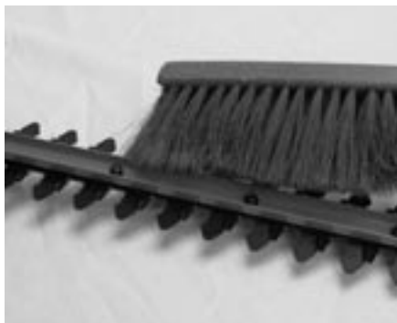
Figure 4-2 : Nettoyage des lames
